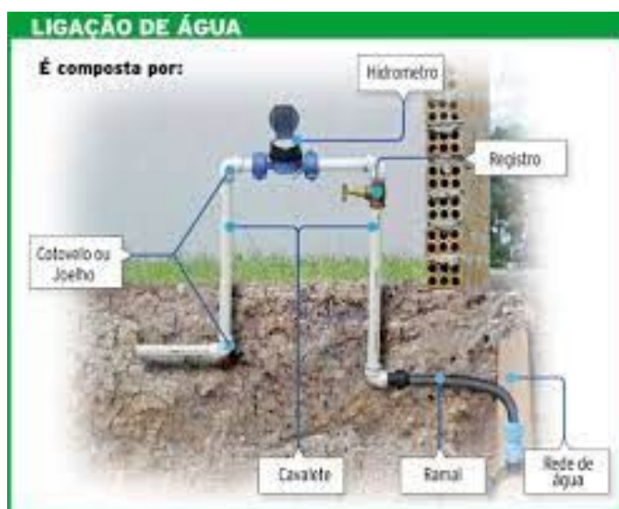
Croqui de cavalete substituído
